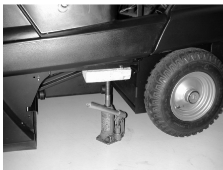
Bod uchytenia pre zdvihák vozidla (zadné koleso)
