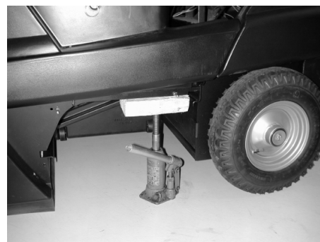
Kocsiemelő felfektetési pontja (hátsó kereknél)
