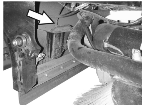
Conexão de mangueira para a caixa de pressão negativa de descer a escova lateral
